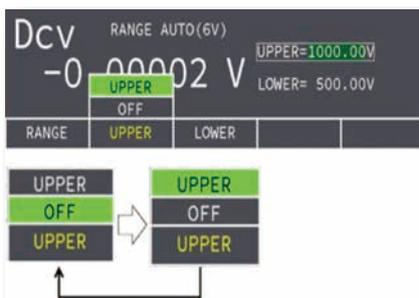
UPPER/LOWER 可以通过比较器功能设定, 电阻和电压可以由独立的比较器同时判定。判定结果显示在显示屏上。外部 I/O 可用于信号输出。
