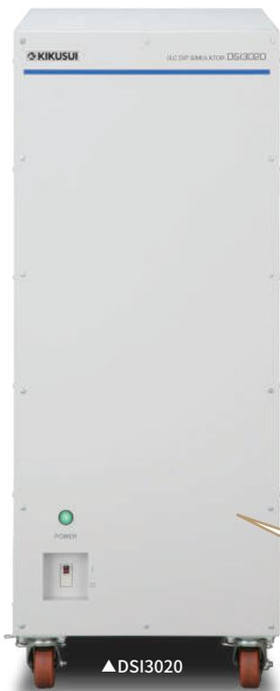
DSI系列是用于构建符合IEC61000-4-11(2004)标准的“电压骤降/瞬时停电及电压变动抗扰度试验系统”的选件单元。可与本公司生产的交流电源PCR-LE/LE2系列组合使用。支持试验所要求的高速电压切换(上升沿时间1μs~5μs)、电压骤降(0%、40%、70%、80%)及相电压/线间电压骤降试验。
