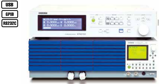
FC阻抗测试仪KFM2150不能单独使用，需与本公司制造的PLAZ-4W系列电子负载装置装配在一起才能进行标定。
