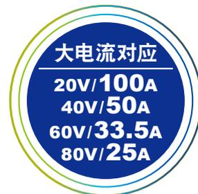
● PBZ SR 系列是双极性方式的大功率直流稳压电源。它以智能型双极性电源 PBZ 系列为基础,使用专用并联组装部件(多台并联)组装起来的,可对应大电流(Max ±100A)需求的机型。
