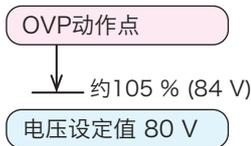
例 2. 当电压设定限制为 ON, 在电压设定值设在 80 V 后, 设定 OVP 工作点的情况
