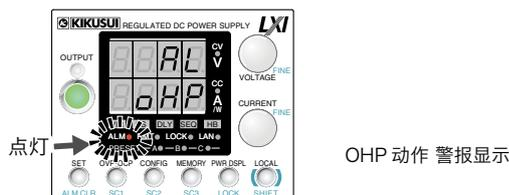
即使再次打开 POWER 开关, 如果不排除 OHP 动作的原因, OHP 将再次动作。
