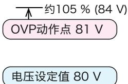
例 3. 当电压设定限制为 OFF, 在 OVP 工作点设在 81 V 后, 设定限制变为 ON 的情况 (电压设定值约 80 V)
