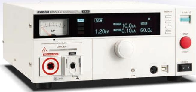
「TOS5300系列」是对电器产品必须进行安全确保 4项测试中的耐电压测试，绝缘阻抗测试的测试仪器。输出为 5kV/100mA(AC)，6kV/10mA(DC)，基于在 IEC，EN，UL，VDE，JIS等各国安全规定或电器产品安全法的要求之上，可对电子器械，电子部品进行耐电压 / 绝缘阻抗测试。还有，采用了新研发的开关放大器，使测试电压的安定性更高。因为不受 AC输入端电压和频率变化的影响，可保持安定的输出电压，所以在电源环境不安定的区域也可进行安定，安心的测试。装备有充实的对应各式各样用户要求的机能。这是一款基于操作性·实用性·安全性为一体，性价比高的机种。
