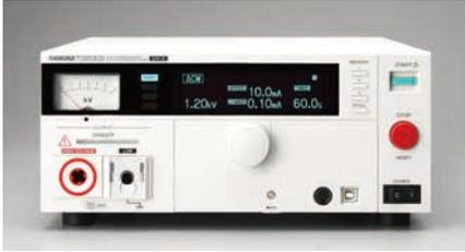
电子设备的生产流水线或检查流水线的工人很多情况下并不一定是专业技术人员，很有可能在不注意的情况下就改变了仪器的设定而导致误操作。为了防止这种现象发生，在配备了按键锁定功能的同时，还安装了无法对面板实施物理性操作的盖板。
