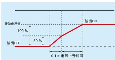
▲可以将开始电压设定为测试电压的 50%
