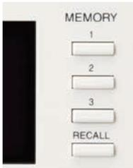
测试电压，判断值，测试时间的设定只需按下按键，旋动面板中央的旋钮。进行一次设定之后的测试条件可以存储记忆到面板存储器当中。(3套)
