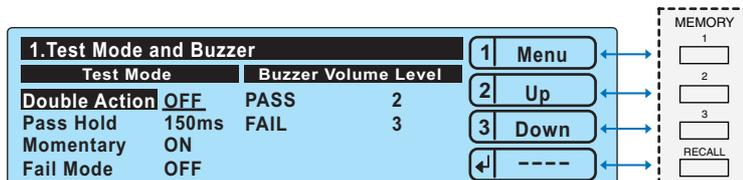
在 Configuration Menu 的 2. Test Mode and Buzzer 选择 Double Action 设定的例
