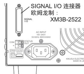
为了避免由于噪声引起误动作，请使用遮断型 D-sub 25 针连接器以及 2.5 m 以下的电缆。
