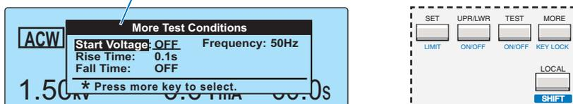
按下SHIFT键的同时按SET键时，可以选择Limit Voltage（限制电压）。（选择限制电压值的例）
