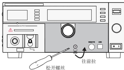
松开螺丝将外罩的中下部扣环往前拉，然后，将外罩从显示屏取下来。
