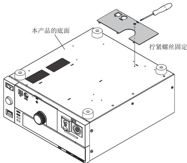
在固定的测试条件下反复进行测试而不使用外罩进行操作时，将外罩收藏到本产品的底面。可以防止丢失。
