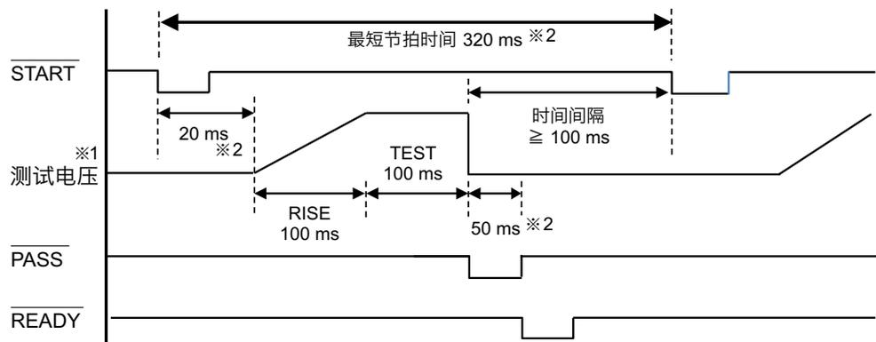
※1 测试电压由简易的+（正）极的包络线表示。
