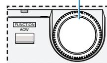
如果按 SHIFT 键的同时转动旋转按钮，设定值得动作速度会改变。根据旋转按钮的转动大小，可以设定切换倍速在 2 倍，4 倍，8 倍。
