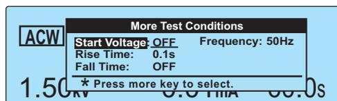
在测试模式 ACW 的 More Test Conditions，选择 Start Voltage 设定的例。
