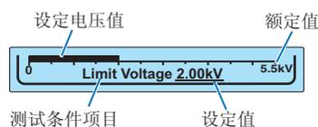
超过所设定的限制电压值以上的电压值设定的例
