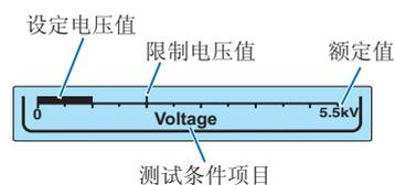
限制电压值 设定中的例
